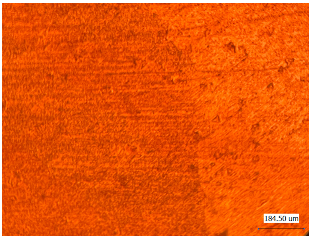
Figura 39 - Observação metalográfica do centro da seção do lingote (Amostra 3 - blend com degaseificação por 2 minutos)
