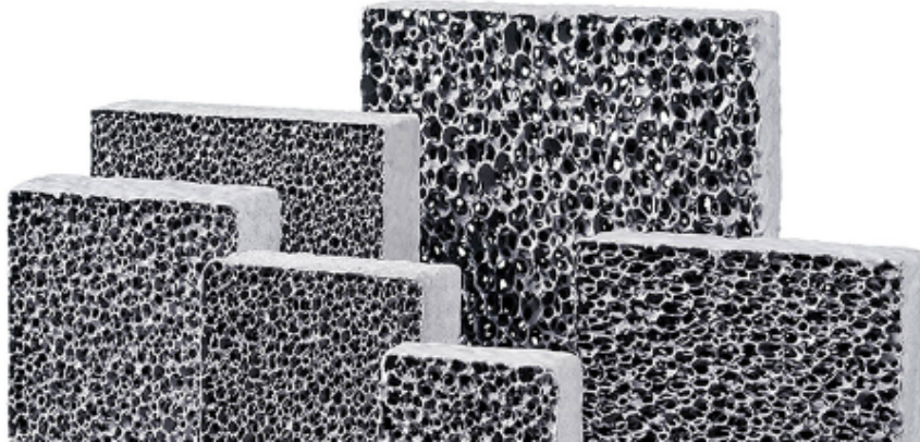
Figura 3 - Filtros cerâmicos de aplicação metalúrgica [22]
