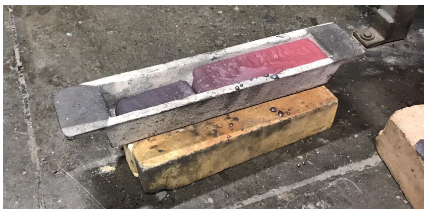
Figura 31 - Cobre sendo resfriado em lingoteira
