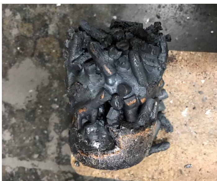
Figura 29 - Material semi-fundido retirado do cadinho de carbetto de silício
