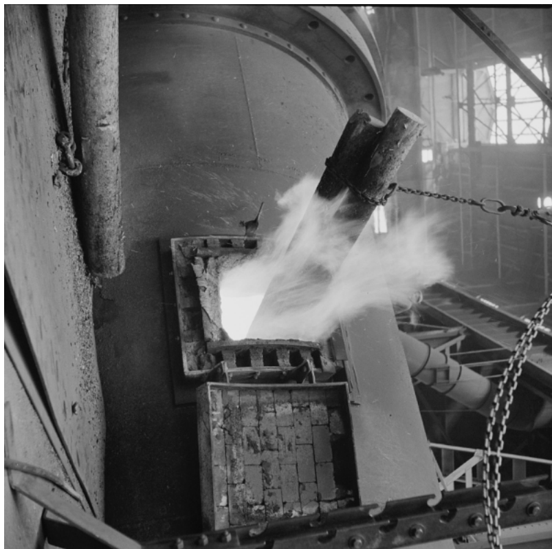
Figura 6 – Introdução de toras de madeira em fundição de cobre para desoxidação [30]
