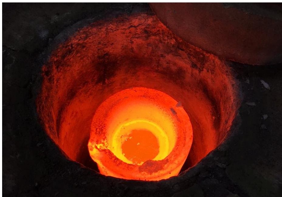
Figura 30 - Cobre completamente fundido no cadinho de grafita
