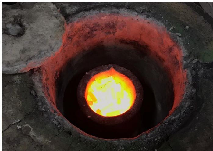
Figura 28 - Cadinho de carbetto de silício após algum tempo no forno
