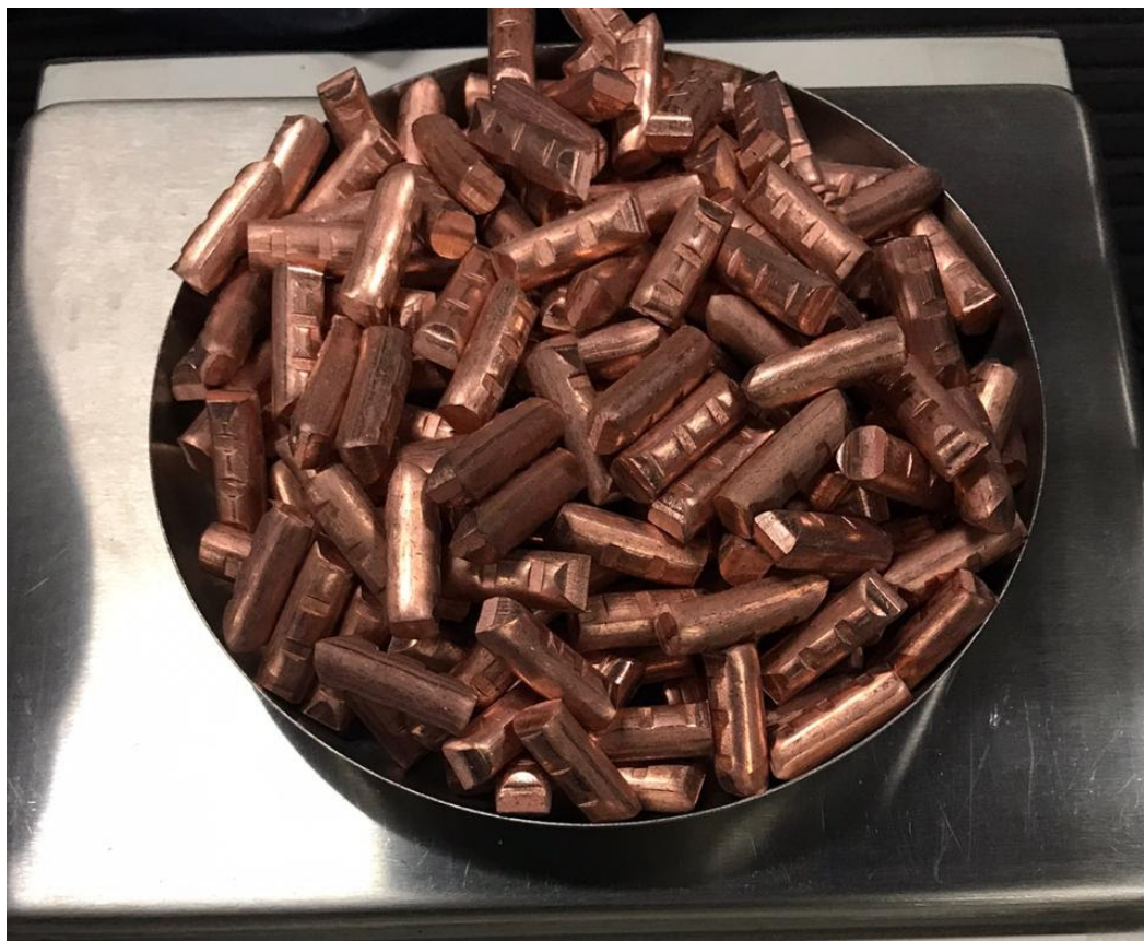
Figura 25 - 2 kg de granalha de cobre refinado a fogo utilizados como matéria-prima
